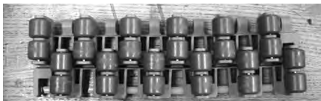
Figura 189: Montagem em incrementos de duas fileiras
