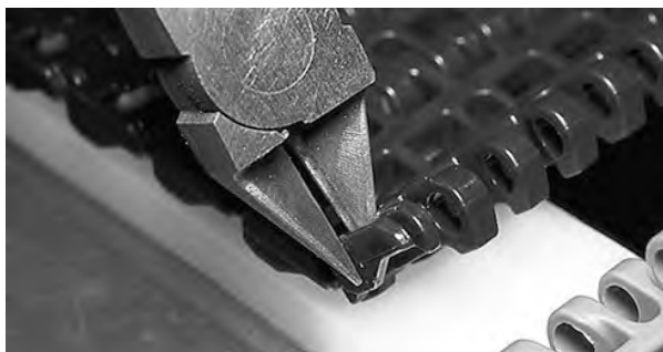
Figura 150: Corte o membro da borda
