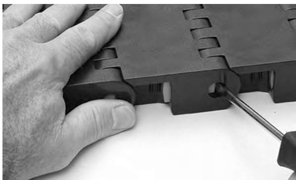
Figura 257: Abra o Slidelox
