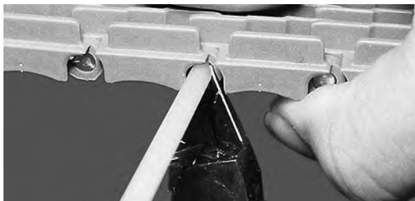
Figura 24: Corte a vareta rente à borda da esteira
