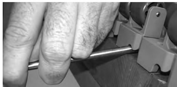
Figura 193: Insira o pino de aço na articulação
