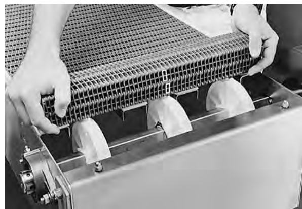
Figura 10: Enrole a esteira em torno das engrenagens
