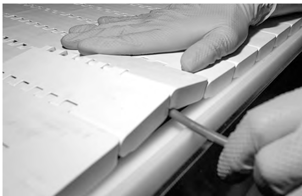
Figura 88: Dobre levemente e insira a vareta pelas articulações
