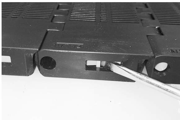
Figura 212: Abra o Slidelox
