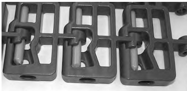
Figura 117: A vareta se expande até a borda lisa
