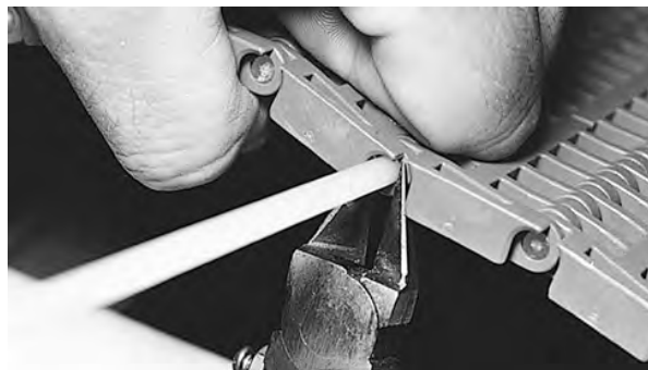
Figura 113: Corte a vareta rente à borda da esteira
