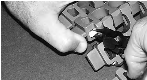
Figura 273: Livre a vareta da peça de retenção
