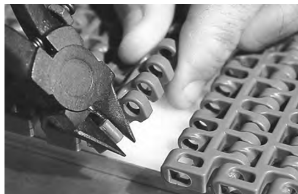
Figura 152: Corte a borda da esteira
