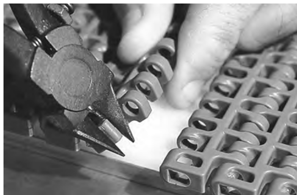
Figura 142: Corte a borda da esteira
