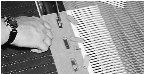
Figura 18: Instale pentes de transferência usando parafusos plásticos da Intralox
